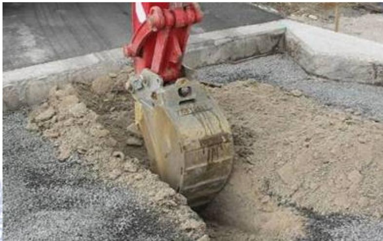
Essai de ré-excavabilité
