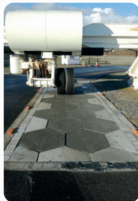
Test de dalles de chaussée urbaine démontable © MIT
