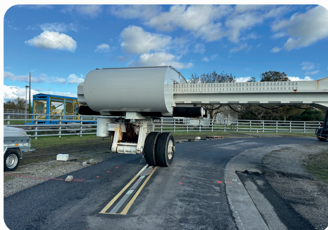
Test d'un rail pour l'alimentation des poids lourds électriques © LAMES
