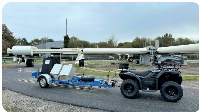
Réalisation de mesures de déflexion avec un FWD © LAMES
