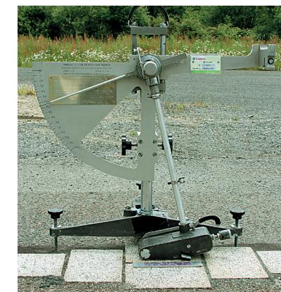
Réalisation d'une mesure d'adhérence au pendule SRT après chargement avec la machine FABAC
