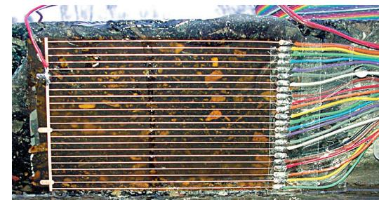
Jauge de fissuration collée sur une structure en enrobé
