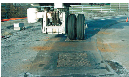
Test de pièces de voiries
