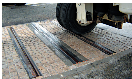
Test de chaussées de tramway
