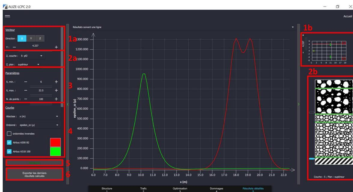
Figure 3.38 : configuration de la fenêtre de visualisation des résultats suivant une ligne
