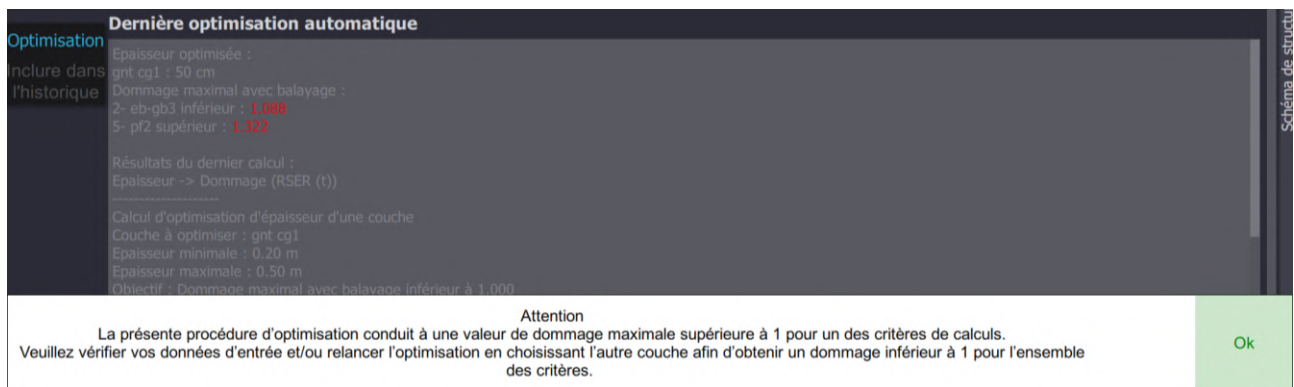
Figure 3.32 : message d'alerte en cas de non-respect d'un ou de plusieurs critères d'optimisation (dommages > 1)
