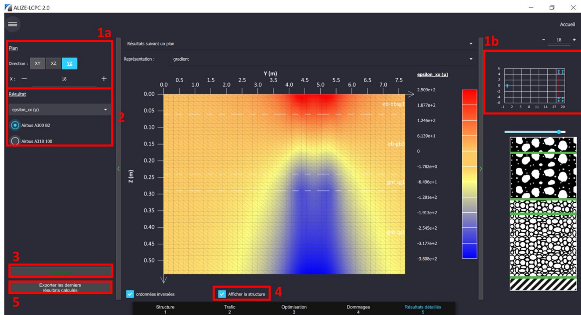
Figure 3.41 : configuration de la fenêtre de visualisation des résultats suivant un plan (cas de la représentation en gradient)
