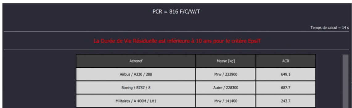
Figure 4.9 : message d'avertissement sur la durée de vie résiduelle de la chaussée
