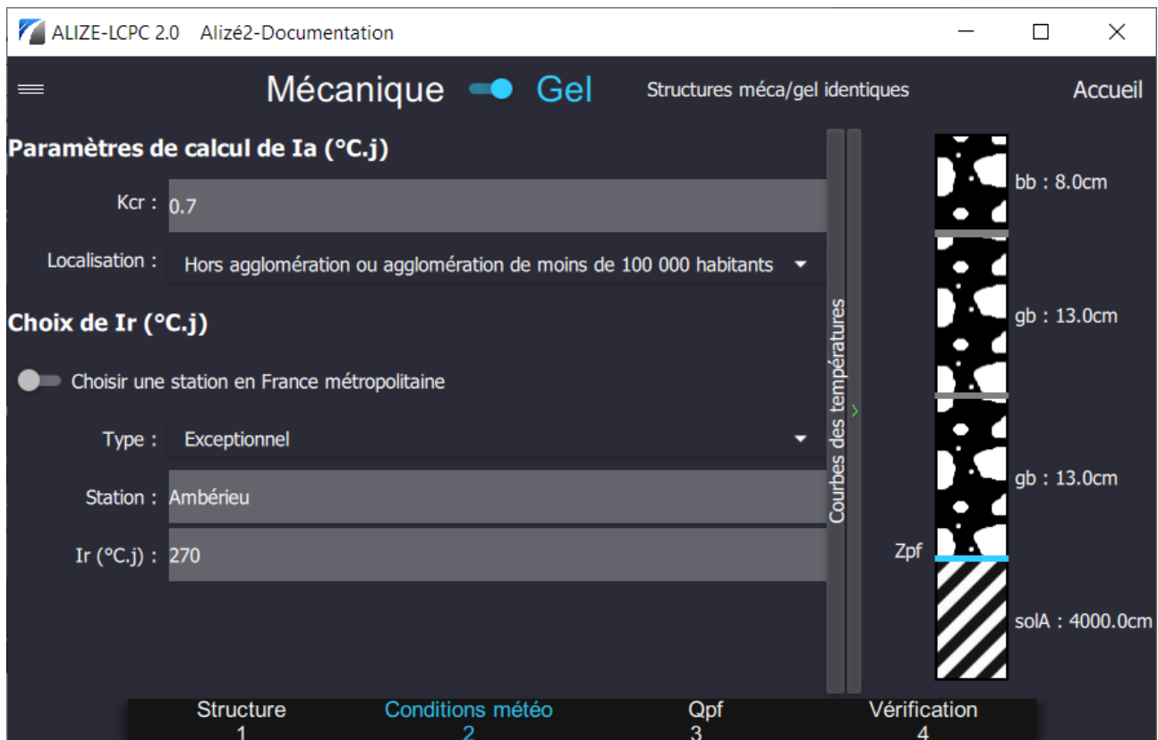
Figure 4.8 - Vue globale de l'onglet Conditions météo
